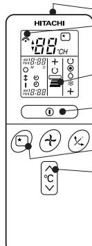
● Окно испускания сигнала/индикатор передачи сигнала
